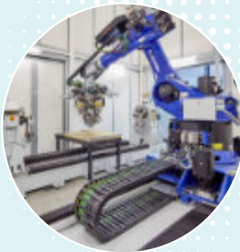
Anlage zur Herstellung komplexer Faserverbundbauteile Foto: WFBB / Fotografen: Büssemeier & Jungblut
